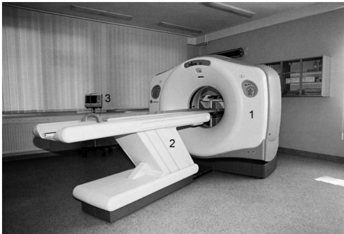
Rycina 2.1. Zestaw do tomografii komputerowej. 1 – okole (gantry) (w obudowie okola znajduje się między innymi lampa rentgenowska wirująca wokół pacjenta i zespół detektorów rejestrujących osłabienie promieni X przechodzących przez badaną warstwę ciała pacjenta), 2 – stół ruchomy we wszystkich kierunkach, na którym umieszcza się pacjenta, a następnie wprowadza do otworu okola, 3 – strzykawka automatyczna do dożylnego podawania środka cieniującego. Urządzenia zasilające, umożliwiające programowanie i kontrolę przebiegu badania oraz rejestrację obrazu, znajdują się w innych pomieszczeniach.
